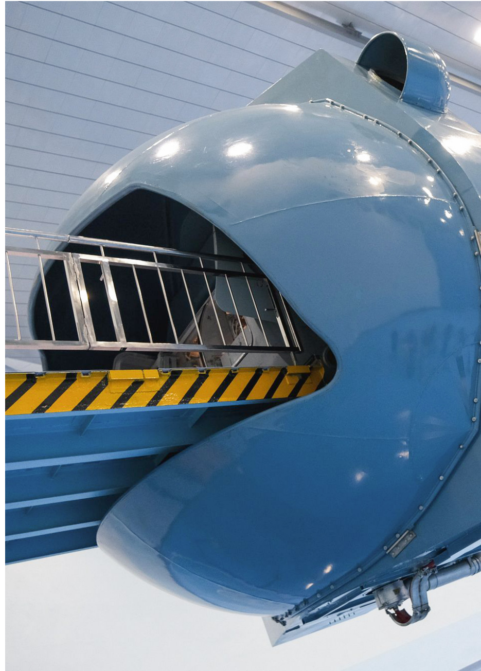
● 300-тонный тренажёр способен вращаться со скоростью более 70 оборотов в минуту
